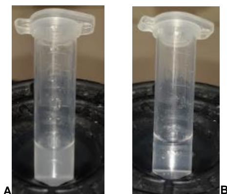
Figura 35 – Fase aquosa de extração líquido-líquido antes (A) e depois (B) de centrifugação a 6000 rpm durante 3 horas.
